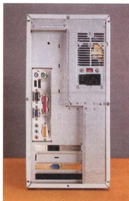
*Osservando le uscite si notano i connettori telefonici della scheda soft-modem a 56K e la seconda seriale. Manca del tutto la presa di alimentazione del monitor, a causa della potenza limitata dell'alimentatore.*
